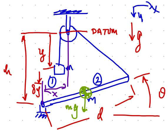
THE BEAM IS PINNED AT LEFT DIRECTLY UNDER THE PULLEY :  $x = 0$
